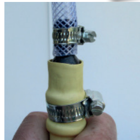
Steg 3. För ner hylsan enligt bild, därefter dra åt slangklämman
