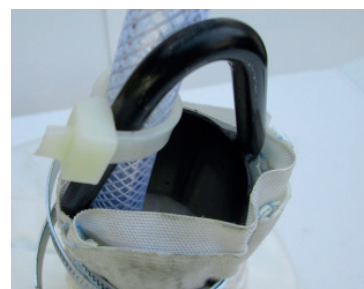
Steg 13. Centrera ballongen i påsarna och fixera luftslangen med plastband i öglan på dragdonet.
